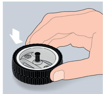
Die **Achsen** lassen sich einfach aus den Rädern lösen, indem man das Rad auf die Tischoberfläche drückt und so die Achse aus der Felge herausschiebt.
